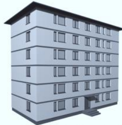
Umlaufende Brandschutzbänderole bei einem mehrgeschögen Gebäude.
