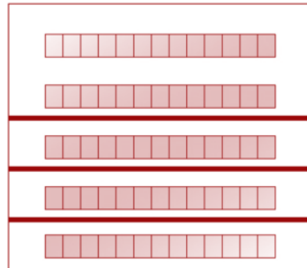
Bild 4 — Beispiel der Anordnung von Brandschutzabschottungen bei Fassaden mit Fensterbändern
