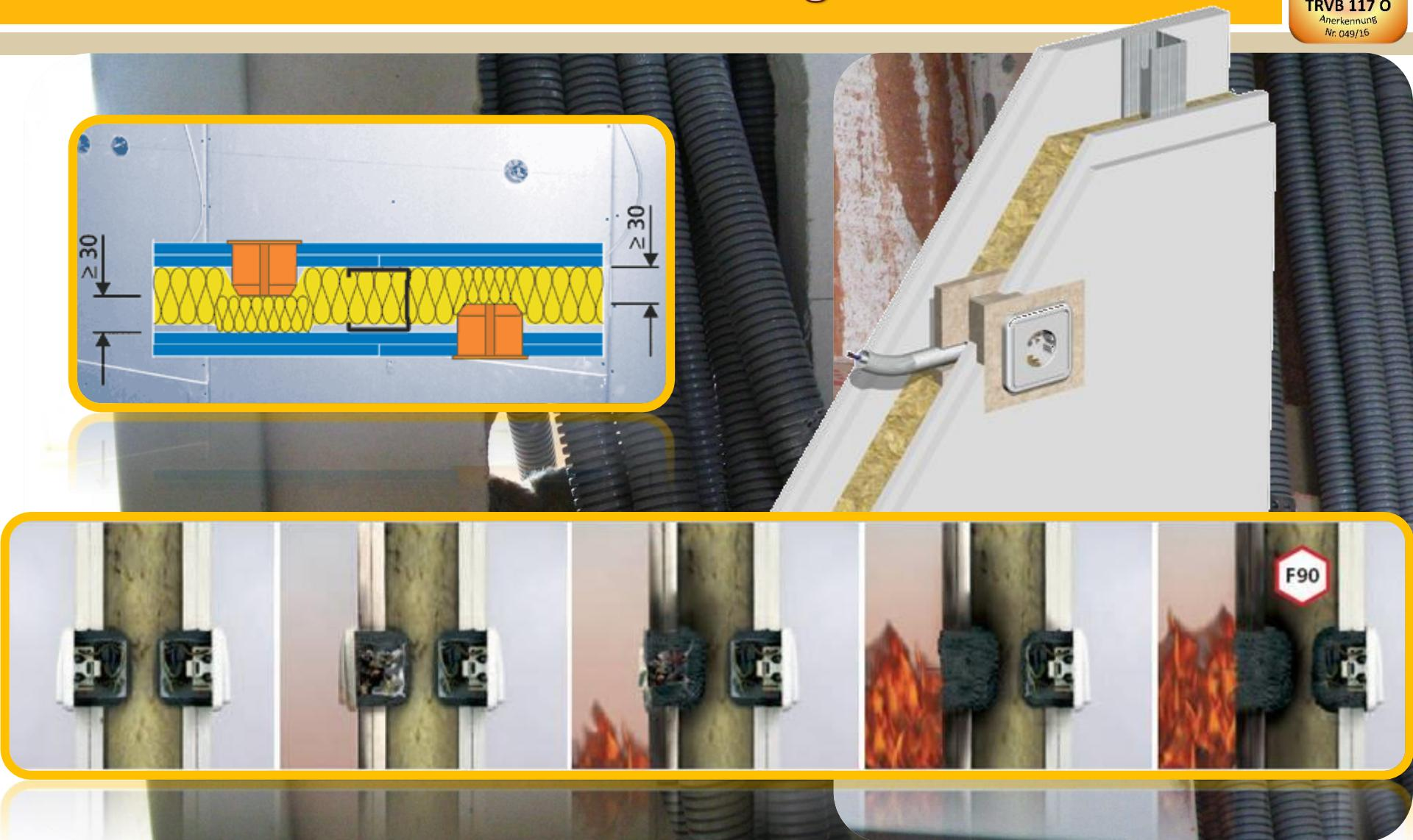
■ (beidseitige) Elektrodosen und Kabelbelegungen
